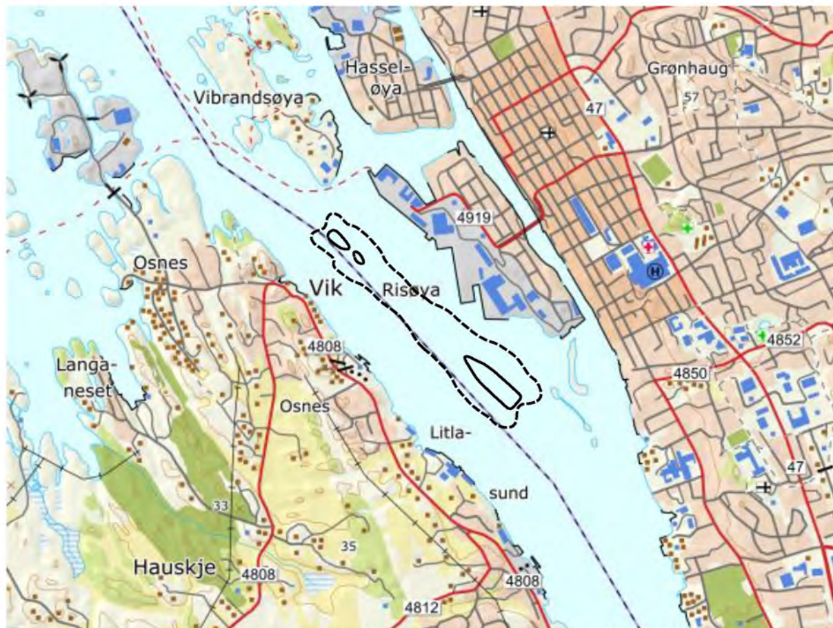
Figur 2-2. Grenser etter Forurensingsforskriften for sjøflyaktivitet i Haugesund. Tiltaksgrense (64 dBA, hel strek) og kartleggingsgrense (57 dBA, stiplet strek). M 1:25 000.
